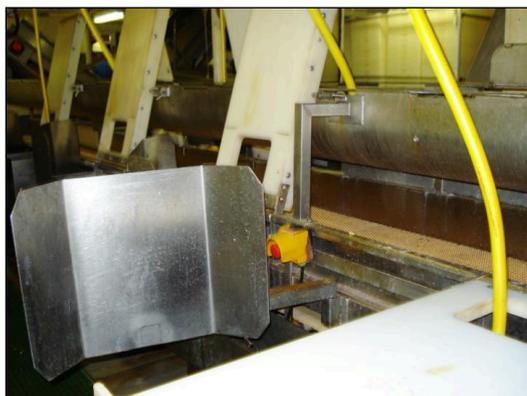
**Figure 77 : support de dos sur les postes de tri du poisson. Source : CNPMEM.**
