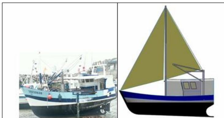
**Figure 69 : Simulation de la mise en place de voiles sur le navire *COMMANDANT COUSTEAU*.**
