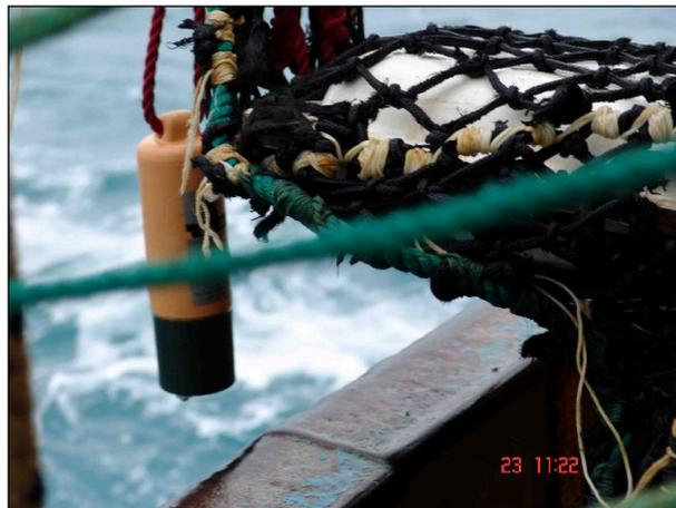
Figure 36 : Répulsif acoustique en place sur un chalut pélagique. Source : Anonyme<sup>3</sup>, 2007.
