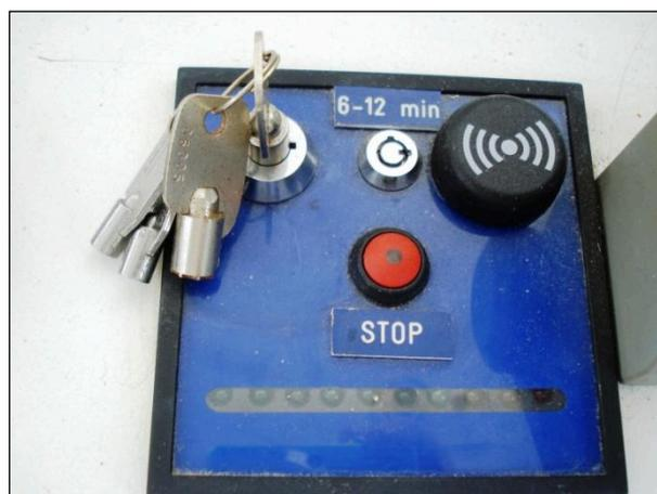
Figure 72 : alarme de vigilance homme de quart mise en place sur le *P'TIT IDEFIX*. Source : CNPMMEM.
