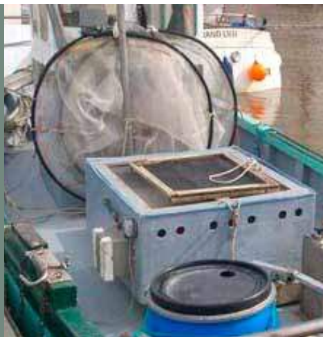
Vivier embarqué équipé d'un aérateur
